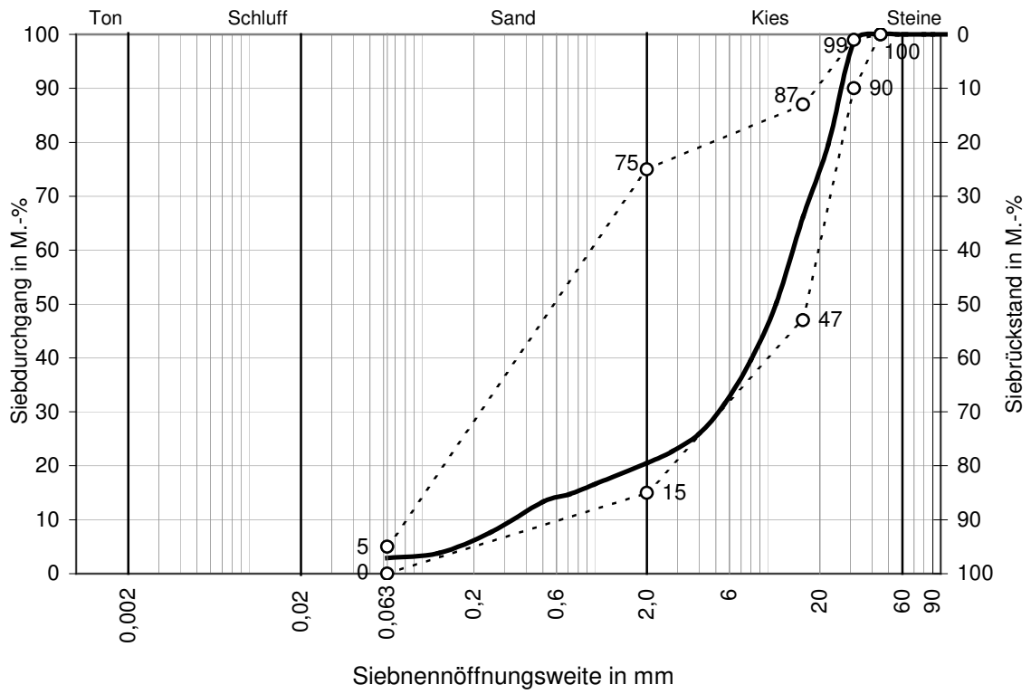
Korngrößenverteilung des Baustoffgemisches 0/32 rd. (FSS)
